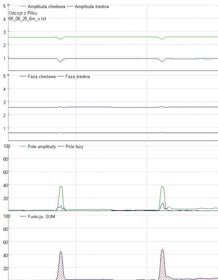
Rys. 1. Dwukrotne przekroczenie strefy detekcji przez obiekt o masie 75kg i prędkości poruszania 6m/s
