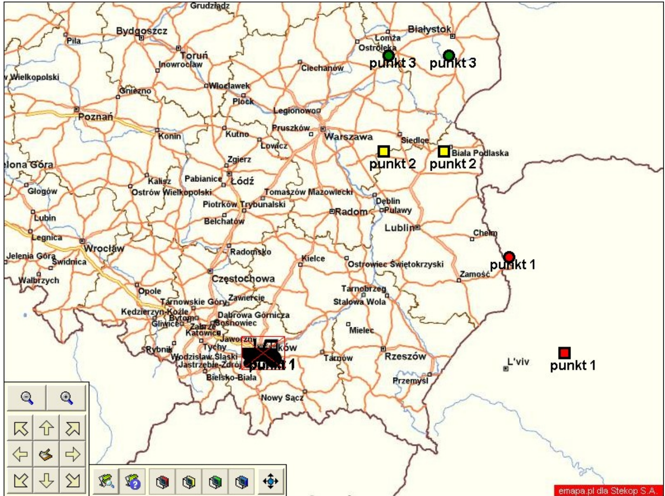
Rys 3. Prezentacja obiektów na mapie w postaci prostych symboli graficznych (typ obiektu) wraz z kolorami (stan obiektu) i obiektu graficznego. Filtry stanów zostały ustawione na wyświetlenie obiektów o wszystkich stanach. Opcja wyświetlania opisów została ustawiona jako aktywna.
